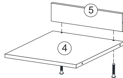
2. Сборка производится горизонтально, тыльной стороной вниз. Вязку 4 скрепить с тягой 5 при помощи еврошурупов 7\*50 мм.
