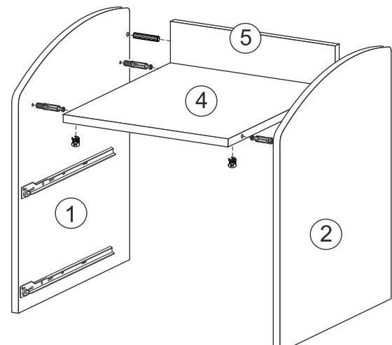
3. Предварительно на боковины 1 и 2 установить направляющие ящиков 400 мм при помощи евровинтов 6,3\*10,5 мм, а также эксцентрики и шканты..
