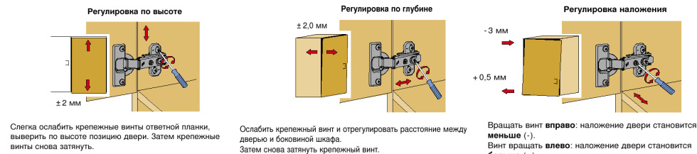
Рис.3 Схема установки петель
