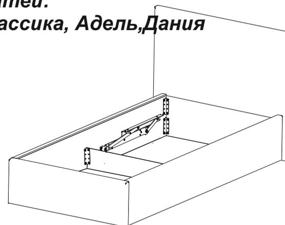
4. Установить перегородку, с помощью уголков СК-1 на винты М6\*20, 8 шт
