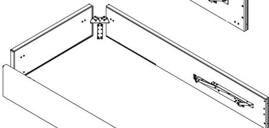
2. Соединить боковые и ножную царгу при помощи уголков СК-1, кронштейнов кровати стяжки СК-2 на винты М6х20, 16шт.
