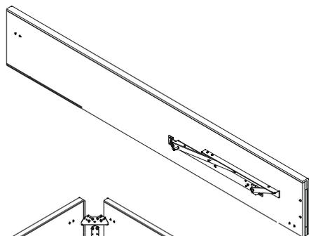
1. Установить механизм трансформации на боковые царги при помощи винтов М6х20, 4+4 шт.
