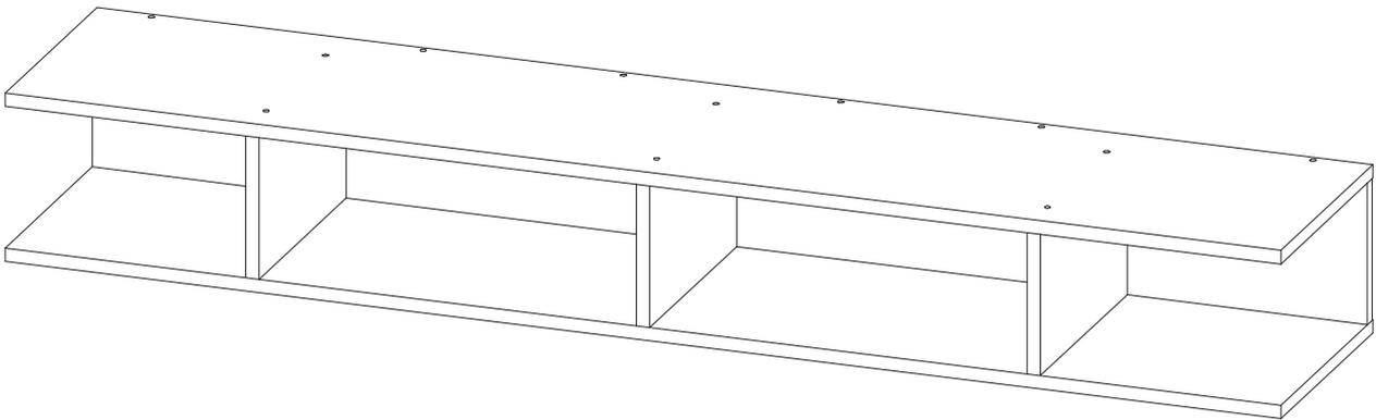
Нагрузка - не более 5кг при равномерно распределённых статических нагрузках.
