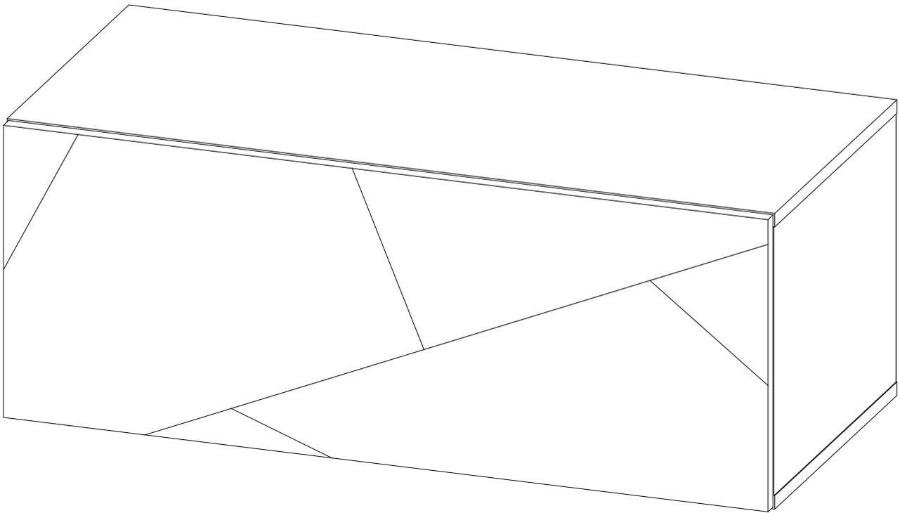
Нагрузка - не более **15** кг при равномерно распределённых статических нагрузках.
