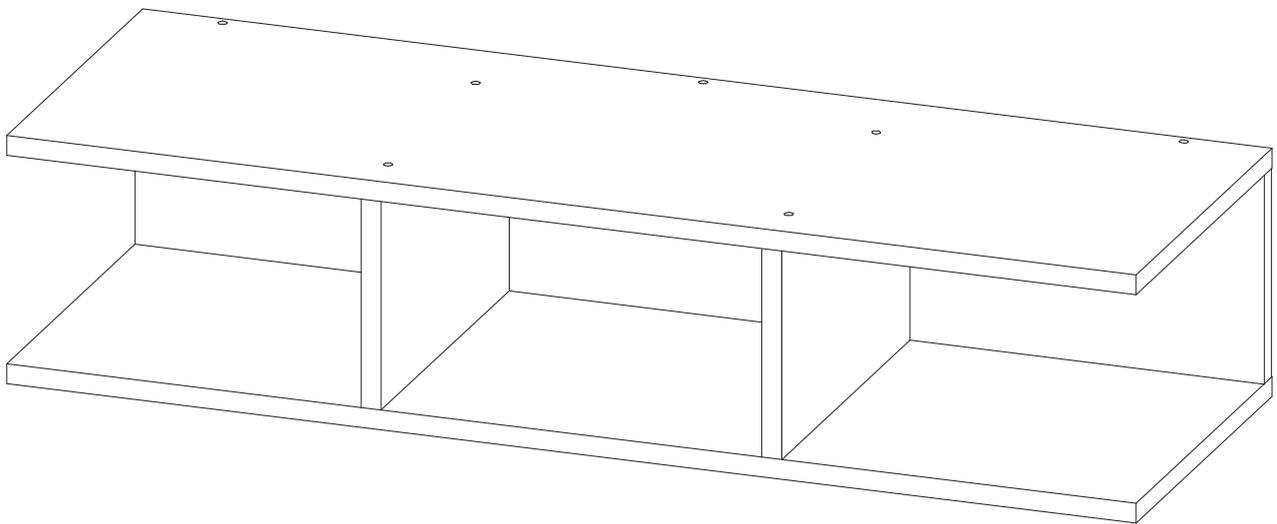
Нагрузка - не более 5кг при равномерно распределённых статических нагрузках.
