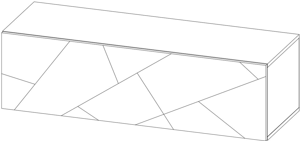
Нагрузка - не более **15** кг при равномерно распределённых статических нагрузках.
