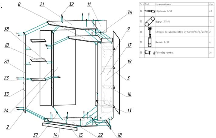
6. Произвести сборку ящиков, согласно указанной схеме. Фасады ящиков крепятся при помощи эксцентриковых стяжек. Внимание!!! Перед крепежом ДВП измерьте диагонали во избежание перекосов ящиков. Закрепите нижние направляющие на ящиках при помощи шурупов 3,5\*16.
