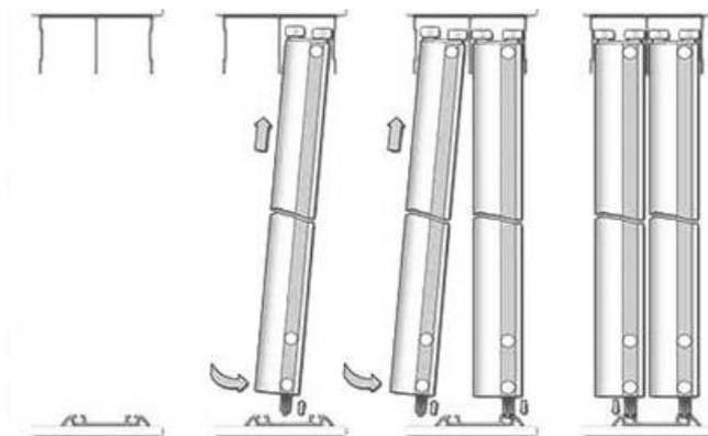
10. Установите ящики. После установки ящиков фасады следует закрепить шурупами 4\*30 через детали № 11. Перед закреплением фасадов ящиков шурупами убедитесь, что ящики подходят по высоте и фасады расположены симметрично.
