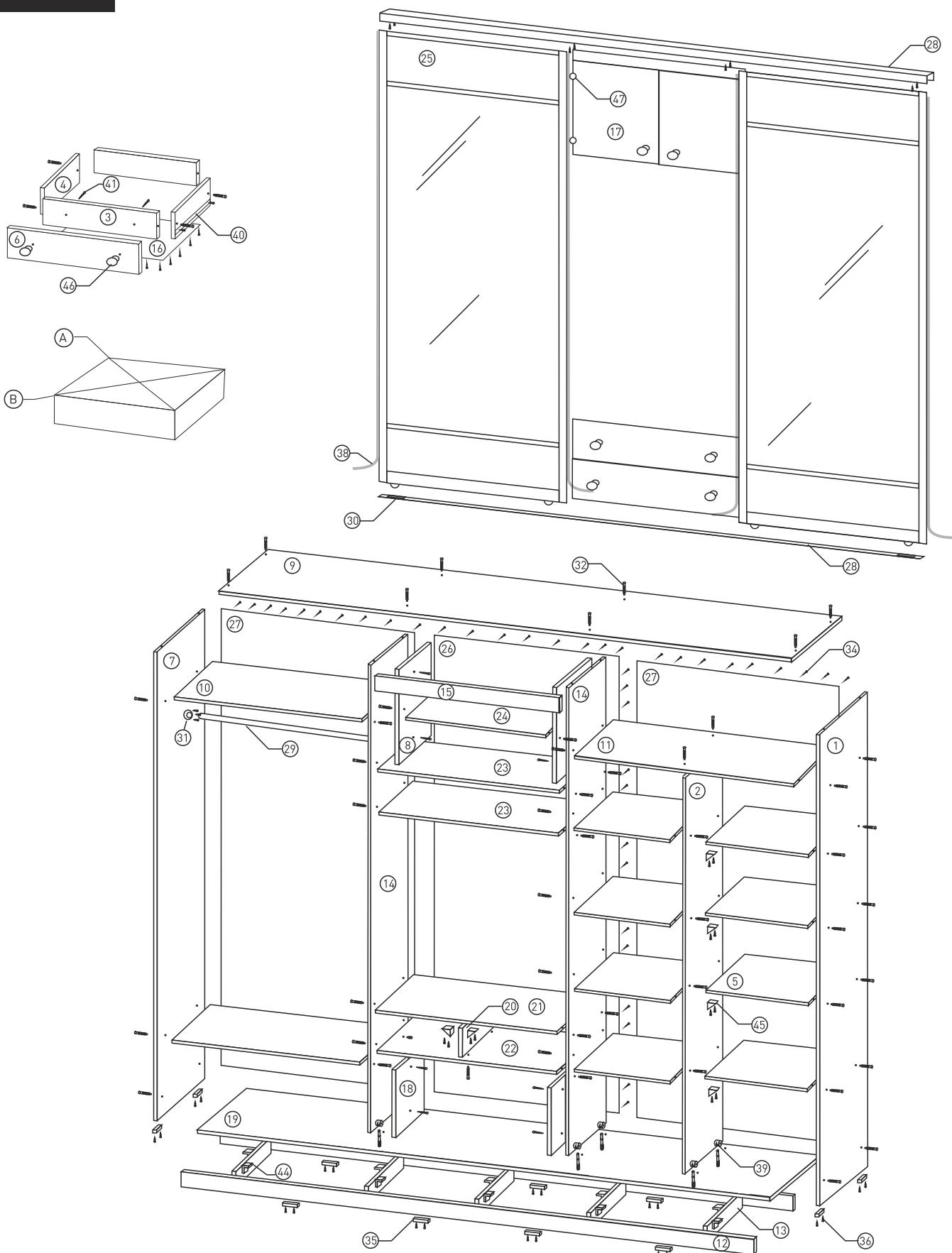
**ВНИМАНИЕ!** Распашные двери устанавливаются только после установки верхней и нижней рельсы. Нижняя рельса крепится от лица дна с отступом 18-20 мм на двухсторонний скотч.
