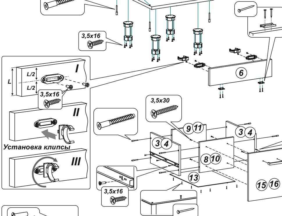
После сборки изделия и установки его по месту, рекомендуем стягнуть его с соседними модулями межсекционными стяжками. Для этого необходимо предварительно просверлить отверстия Ø5-6 мм
