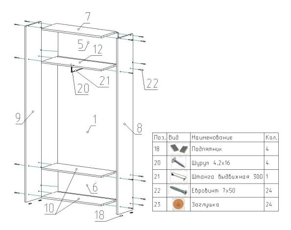
На боковины **8** и **9** по нижнему торцу, отступив от края 3-4 см, прикрутите шурупами 3x20 подпятники, по 2 шт. на каждую деталь. Между боковинами **8** и **9** с помощью евровинтов закрепите полки **7**, **10** и
