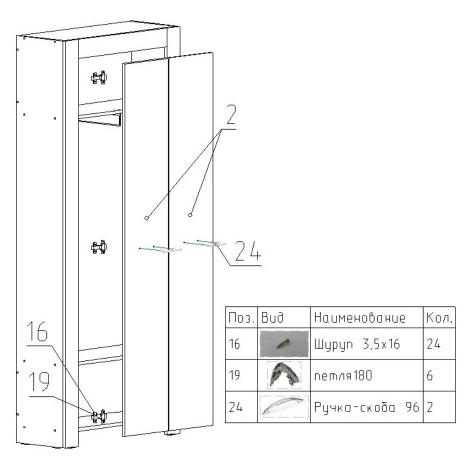
Шурупами 3,5 х 16 согласно разметке, прикрутите, к вертикальным планкам **4** и **11** ответные планки от петель. На фасады **2** прикрутите петли, для крепежа так же используйте шурупы 3,5\*16.
