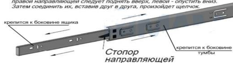
Рис.2 Схема установки шариковых направляющих
