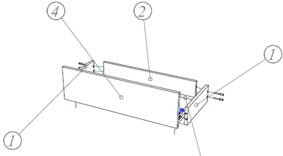
2. С помощью эксцентриковой стяжки и шкантов соединяем фасад 4 с боковинами 1. К боковинам ящика 1 евровинтами прикручиваем заднюю панель ящика 2. На получившуюся конструкцию гвоздями набиваем ДВП 3, предварительно убедившись в равенстве диагоналей корпуса выдвижного ящика.
