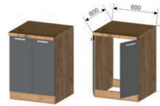
Корпус: ШНМС 600 (ШхВхГ): 600x806x550 мм Фасад: ШНМС 600 (ШхВхГ): 296x703x16 мм (2 шт.)
