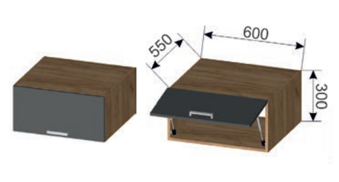
Корпус: ШАН 600 (ШхВхГ): 600x300x550 мм Фасад: ШАН 600 (ШхВхГ): 596x296x16 мм (1 шт.)
