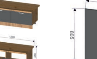
Корпус: ШНТБ 1200 (ШхВхГ): 1200x354x430 мм Фасад: ШНТБ 1200 (ШхВхГ): 596x350x16 мм (2 шт.)
