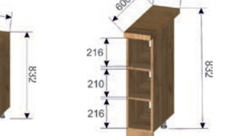
Корпус: ШНДЯ 600 (ШхВхГ): 600x706x550 мм Фасад: ШНДЯ 600 596x100x16 мм (1 шт.)
