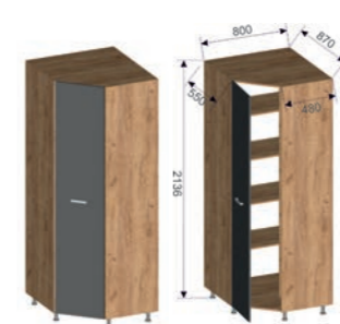
Корпус: ШЮ-800 (ШхВхГ): 800x2036x870 мм Фасад: ШЮ-800 (ШхВхГ): 426x2033x16 мм (1 шт.)
