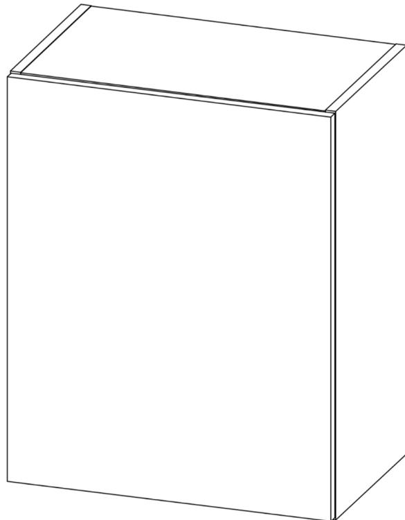
Высота ниши под встраиваемую вытяжку 135 мм. Установку вытяжки и вырезы под воздухоотвод производить по инструкции и шаблонам прилагаемым к встроенной вытяжке.
