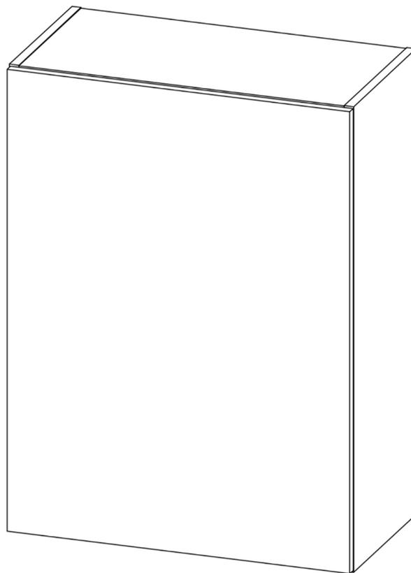
Высота ниши под встраиваемую вытяжку 135 мм. Установку вытяжки и вырезы под воздухоотвод производить по инструкции и шаблонам прилагаемым к встроенной вытяжке.
