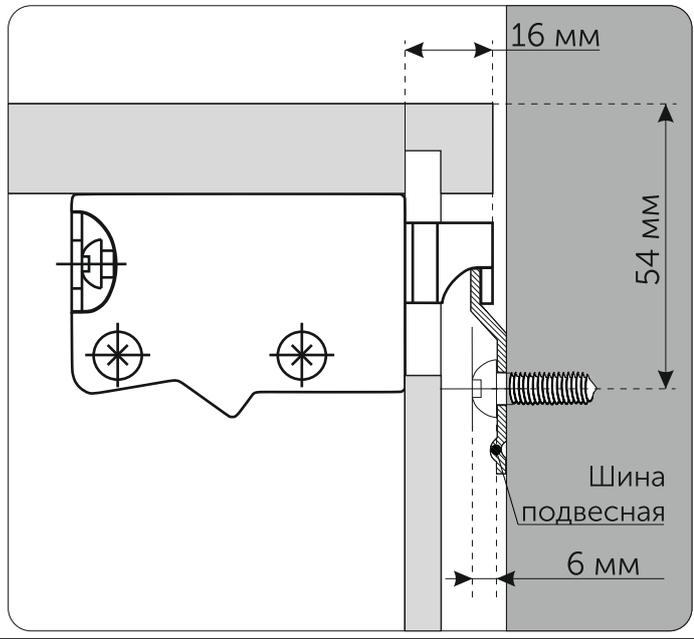
Регулировка положения шкафа при помощи винтов на креплениях «крاب»
