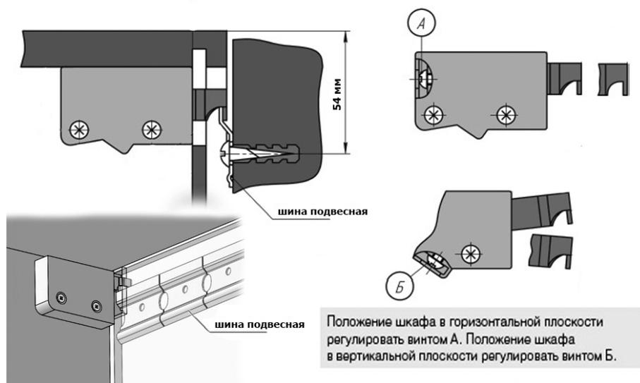
Крепление монтажной (подвесной) шины к стене обычно производится при помощи шурупа 6x60 мм с дюбелем 10x60. Для этого необходимо предварительно просверлить отверстия в стене (кирпич, ж/б плита) при помощи электродрели, либо перфоратора. Отверстия для крепления следует делать в местах последующего размещения регулируемых подвесов навешиваемых шкафов.
