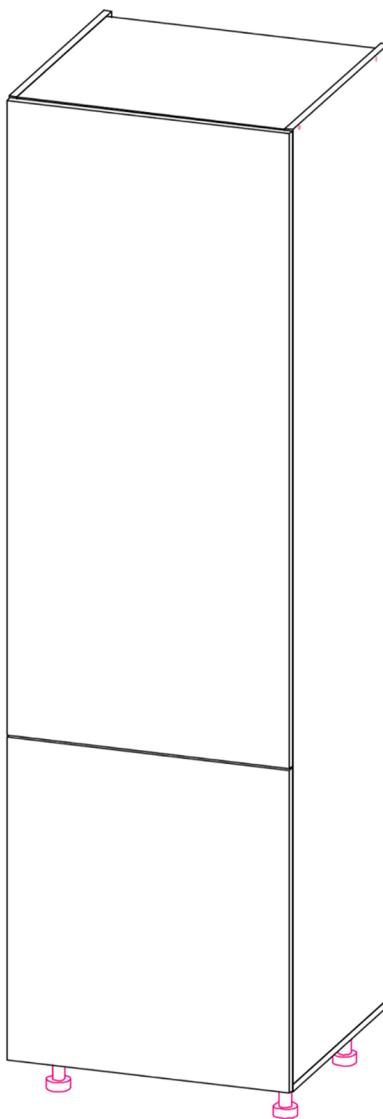
Пенал ОБЯЗАТЕЛЬНО нужно крепить к стене. Данный ПЕНАЛ не имеет в своей конструкции задней стенки которая обеспечивает жесткость геометрии при различных манипуляциях с ним (поднятие, перемещение по площади), по этому очень важно поднимать и перемещать его вдвоем. В комплект фурнитуры входят уголки с декоративной накладкой - они предназначены для крепления вязки (поз.7) на высоте, которую не могут обеспечить стандартные положения отверстий.
