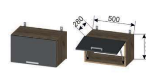
Корпус ШГ 500 (ШхВхГ) 500x300x280 мм Фасад ШГ 500 (ШхВхГ) 496x296x16 мм (1 шт.)
