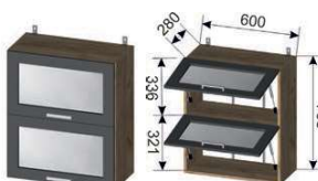
Корпус ШВГ 600 (ШхВхГ) 600x705x280 мм Фасад ШВГГС 600 (ШхВхГ) 596x350x16 мм (2 шт.)
