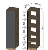
Корпус: ПН2-500 (ШхВхГ) 500x2036x550 мм Фасад: ПН2-500 (ШхВхГ) 496x132x16 мм (1 шт.), 496x703x16 мм (1 шт.)
