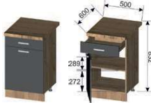
Корпус: ШНЯ 500 (ШхВхГ) 500x706x430 мм Фасад: ШНЯ 500 (ШхВхГ) 496x137x16 мм (1 шт.), 496x560x16 мм (1 шт.)
