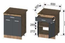
Корпус: ШНЯ 600 (ШхВхГ) 600x706x430 мм Фасад: ШНЯ 600 (ШхВхГ) 596x137x16 мм (1 шт.), 296x560x16 мм (2 шт.)
