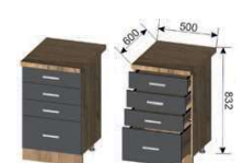
Корпус: ШНЯ 500 (ШхВхГ) 500x706x430 мм Фасад: ШНЯ 500 (ШхВхГ) 496x137x16 мм (3 шт.), 496x278x16 мм (1 шт.)
