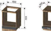
Корпус: ШНД 600 (ШхВхГ) 600x706x550 мм Фасад: ШНД 600 (ШхВхГ) 596x95x16 мм (1 шт.)
