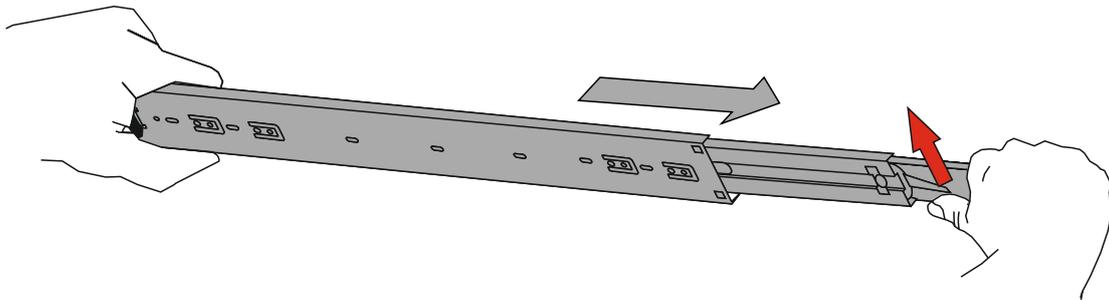
Для того, чтобы разобрать направляющую, необходимо снять внутренние направляющие с помощью деблокирующего рычага.
