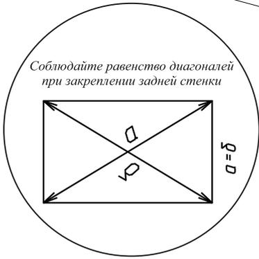
6.) Установить соединительный профиль, выверить диагональ и набить задние стенки ЛДВП 8.
