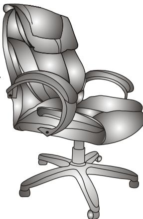
1. В пятилучье ① установите ролики ② , поставьте нижнюю втулку ④ , газпатрон ③ и кожух ⑤
