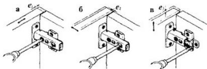
**Схема регулировки дверей после навески на корпус:**
