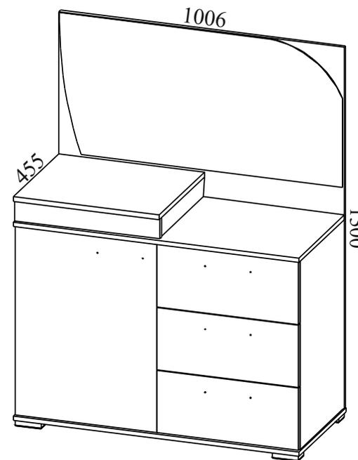
Габаритные размеры: ширина - 1006 мм, высота - 1300 мм, глубина - 455 мм.
