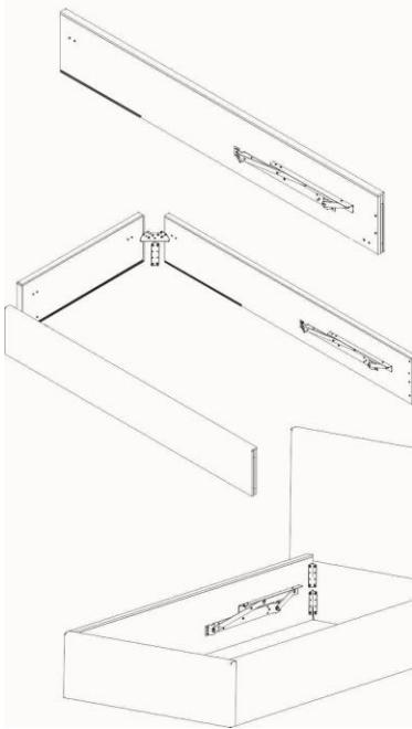
1. Установить механизм трансформации на боковые царги при помощи винтов M6x20, 4+4 шт.
