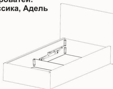
4. Установить перегородку, с помощью уголков СК-1 на винты M6\*20, 8 шт
