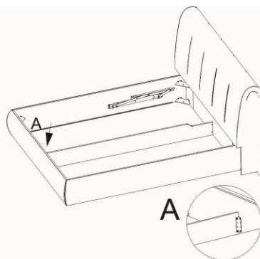
5. Установить центральную перегородку при помощи уголков кроватной стяжки СК-1 на винты M6x20, 4 шт., в перегородку, и винты M6x25, 4 шт., в спинку и переднюю царгу соответственно
