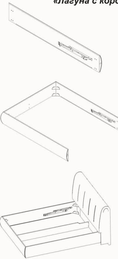
1. Установить механизм трансформации на боковые царги при помощи винтов M6x25, 4+4 шт.
