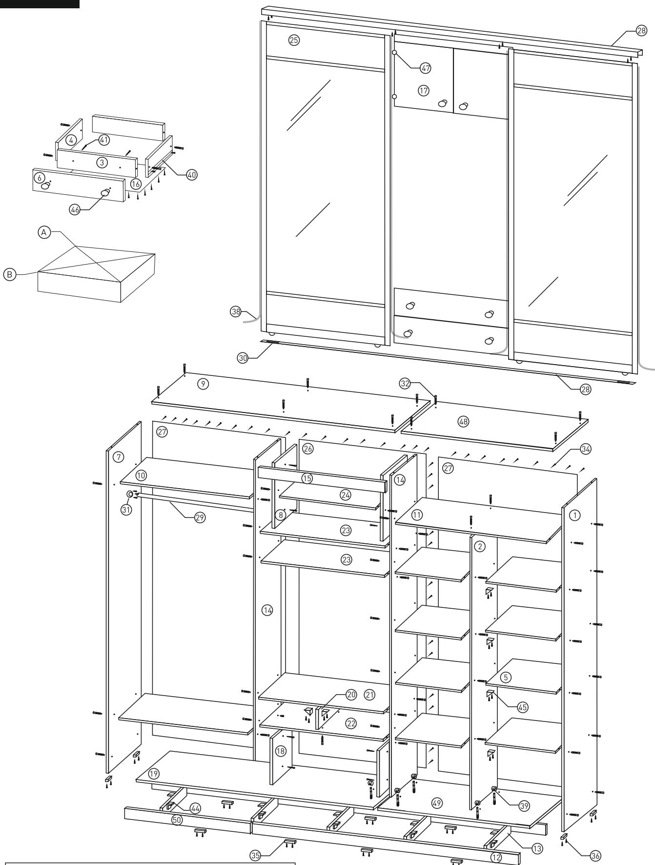
**ВНИМАНИЕ!** Распашные двери устанавливаются только после установки верхней и нижней рельсы. Нижняя рельса крепится от лица дна с отступом 18-20 мм на двухсторонний скотч. При сборке ящиков необходимо выдерживать диагонали А и В, где А=В
