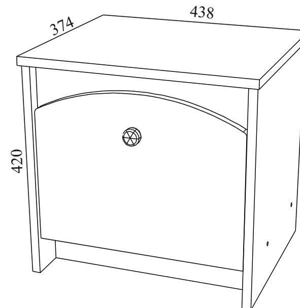
Габаритные размеры: ширина - 438 мм, высота - 420 мм, глубина - 374 мм.
