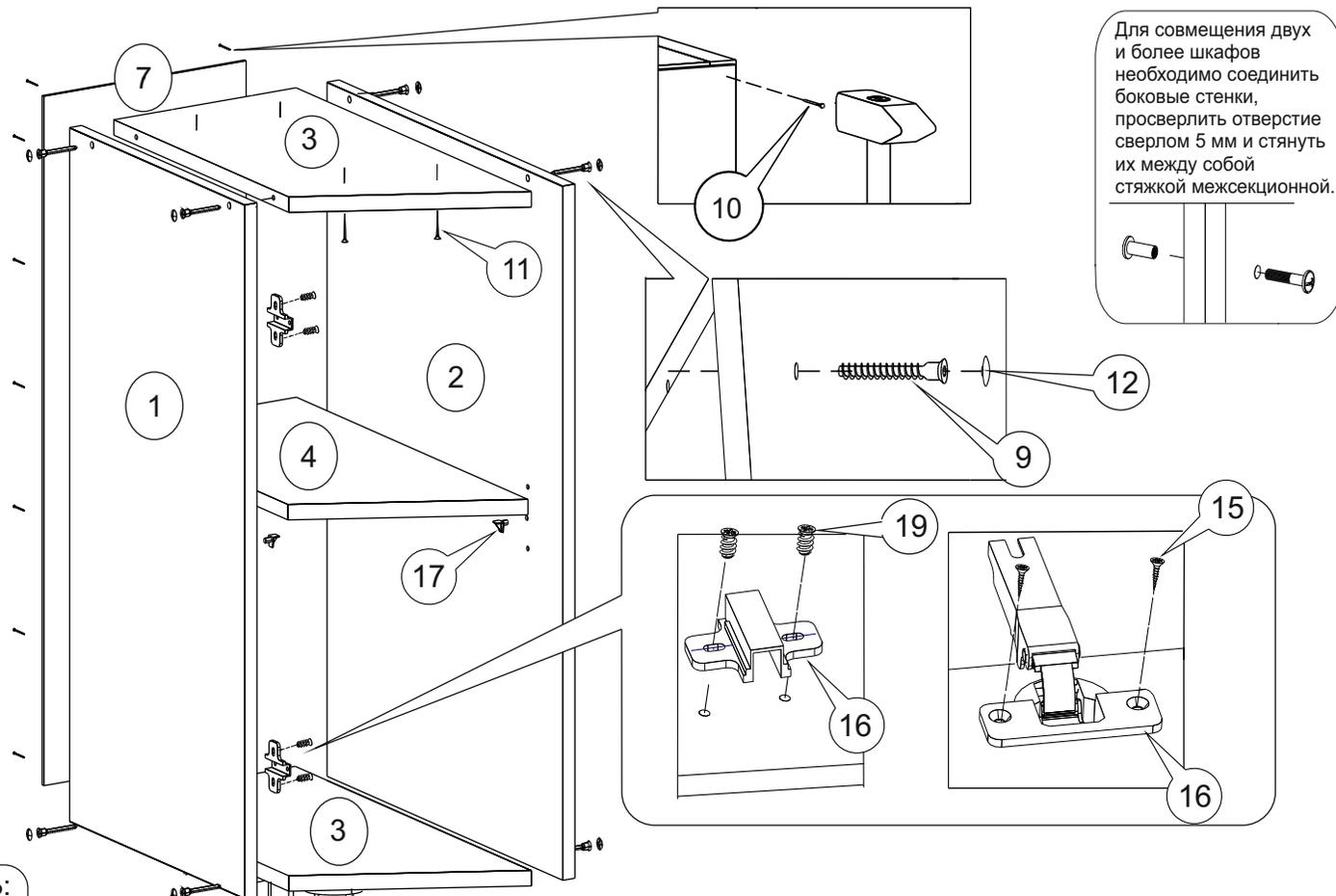
Для совмещения двух и более шкафов необходимо соединить боковые стенки, просверлить отверстие сверлом 5 мм и стянуть их между собой стяжкой межсекционной.
