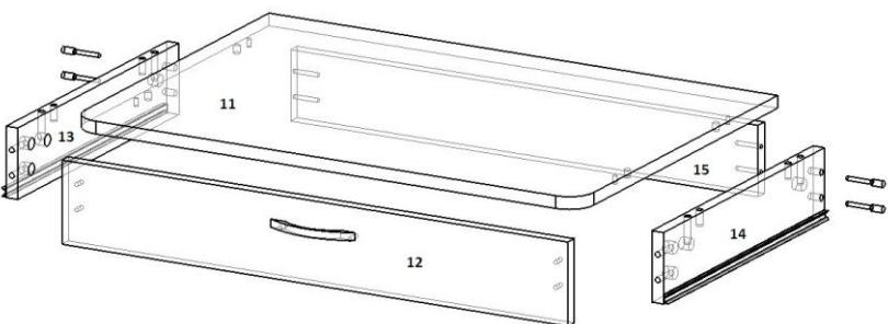
(направляющие полного выдвижения крепятся на БСЯ по краю ЛДСП). Для данного ящика предусмотрена шариковая направляющая шириной — 45 мм.
