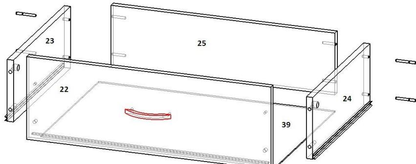
5.2. С помощью эксцентриковой стяжки и шкантов соединяем ПСЯ 22 с БСЯ 23,24. К БСЯ 23,24 евровинтами прикручиваем ЗСЯ 25. На получившуюся конструкцию гвоздями набиваем ДВП 39, предварительно убедившись в равенстве диагоналей. Прикручиваем направляющие полозки 400 мм на БСЯ 23,24 шурупами 3,5x16 (направляющие полного выдвижения крепятся на БСЯ по краю ЛДСП без учета ДВП). Шариковая направляющая шириной — 35 мм.
