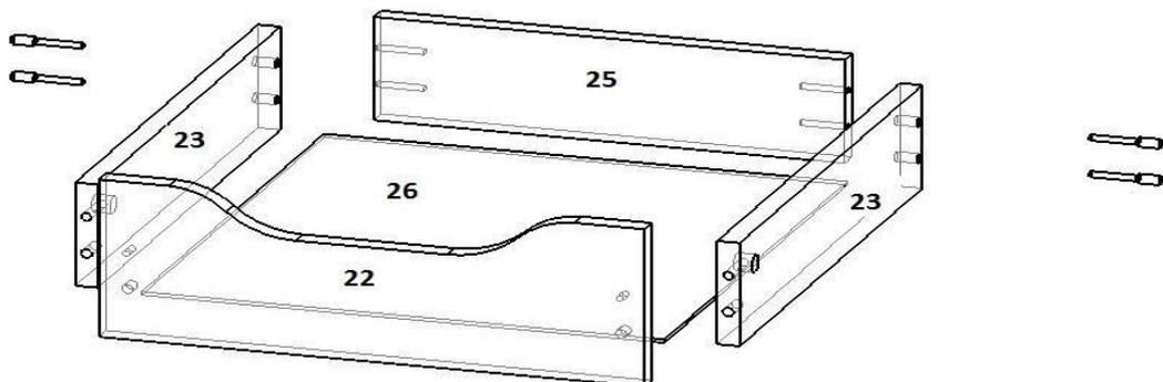
3.3. Прикручиваем направляющие ползки 400 мм на БСЯ 23 шурупами 3,5x16 (направляющие полного выдвижения крепятся на БСЯ по краю ЛДСП без учета ДВП).
