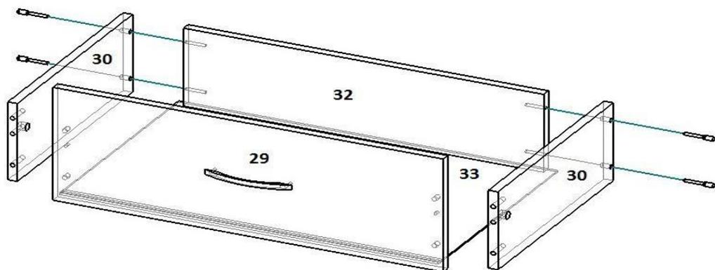
3.5. Прикручиваем направляющие ползки 400 мм на БСЯ 30 шурупами 3,5x16 (направляющие полного выдвижения крепятся на БСЯ по краю ЛДСП без учета ДВП).
