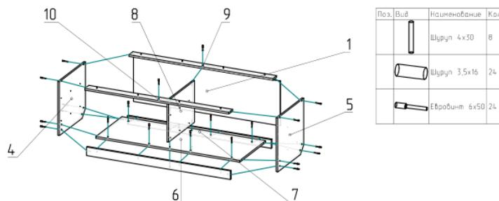
6. Произвести сборку ящиков, согласно указанной схеме. Фасады ящиков крепятся при помощи эксцентриковых стяжек. Внимание!!! Перед крепежом ДВП измерьте диагонали во избежание перекосов ящиков. Закрепите нижние направляющие на ящиках при помощи шурупов 3,5\*16.
