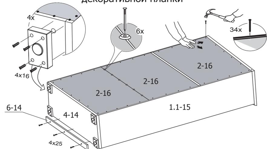
При креплении стенки задней следите за тем, чтобы стенки вертикальные находились под прямым углом к стенкам горизонтальным.
