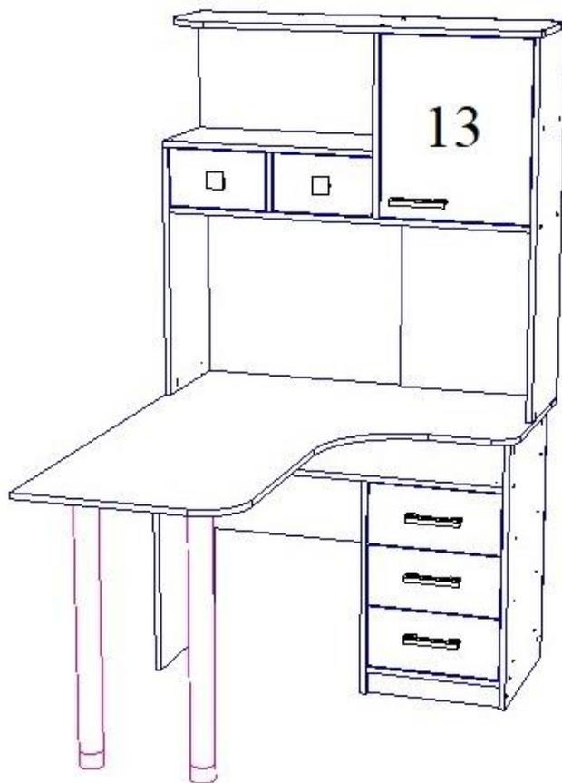
4.10. На дверь 13 крепим шурупами 3,5x16 петли. Прикручиваем ручку. К боку надстройки 3 винтами 6,3\*10,6 прикручиваем монтажные планки петли. Устанавливаем дверь.
