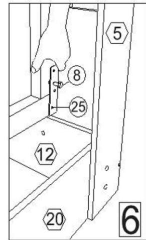
6.1. Установите спинку дивана, закрепив механизмы к рамке матраца болтами М10х50 (поз.8)и саморезом 4х25 в нижнее отверстие механизма.
