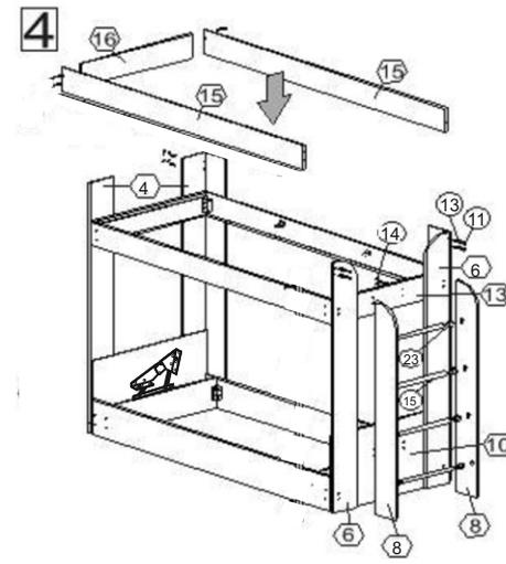
4.1. Соедините между собой дет.15 и 16, скрепив стяжкой-саморезом 7х50 (поз. ).
