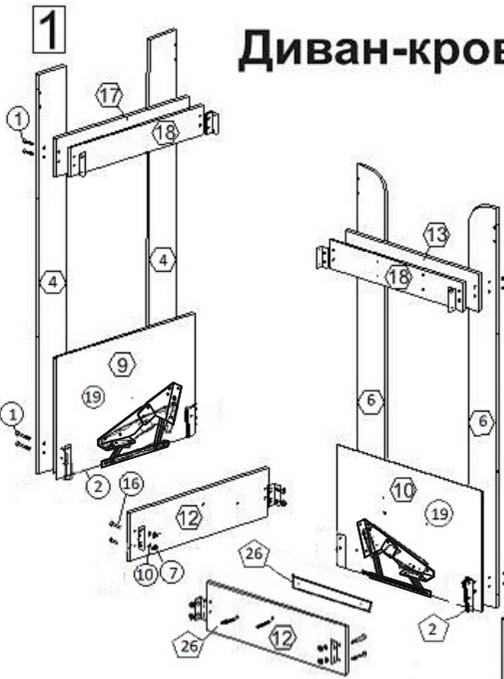
1.1. Закрепите к дет.12 механизм(поз.19) болтами М6х30(поз.5) с гайками и шайбами М6(«П»-правый и «Л»- левый согласно маркировке на механизмах) через проставку под механизм(дет.26)
