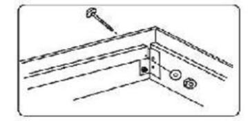
8.1.Вставьте в пазы в верхних царгах дно ДВП (дет.3), зафиксируйте положение деталей, закрутив саморезы 3,5х16 в торцы дет.18 у царг, затем соедините обе детали дна стыковочным профилем (дет.25) и окончательно закрепите к дет.18 и бруску среднему саморезами 3,5х16.
