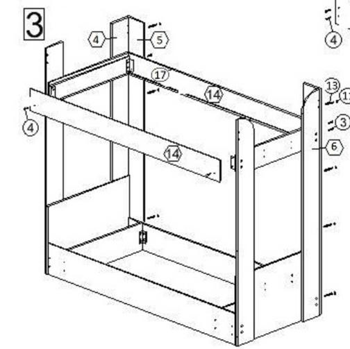
3.1. Закрепите верхние царги (дет.14) к уголкам 388(поз.16): переднюю болтами М6х25, заднюю – болтами М6х40.
