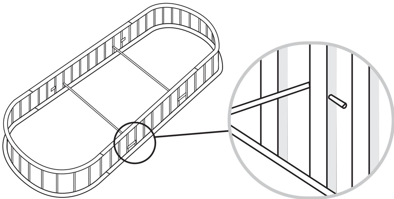
9. Установить на готовый каркас верхние профили, соединяя место стыка профилей фиксаторами (см. п.5). После сборки дополнительно закрепить профиль к профнастилу через отверстия  $\varnothing 3$  мм, используя саморезы 3,5x11 мм
