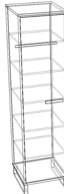
**Конструкция изделия позволяет навесить фасад распашной и установить ручку как на левую сторону, так и на правую!**
