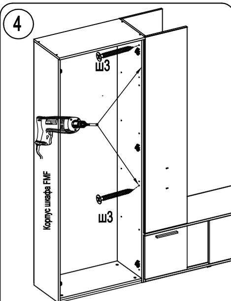
В примыкающем корпусе шкафа FMF высверлить 2 отверстия Ø5. Сдвинуть шкаф и стеллаж, выровнять между собой и стянуть саморезами ш3.
