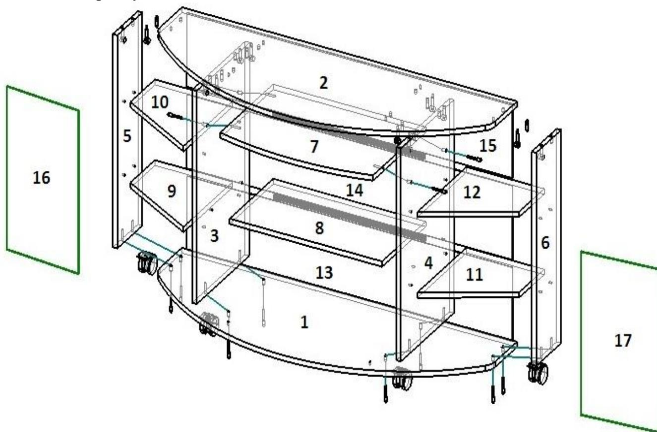
3. На получившуюся конструкцию гвоздями набиваем ДВП 13, 14, 15 через соединительную планку, предварительно убедившись в равенстве диагоналей.
