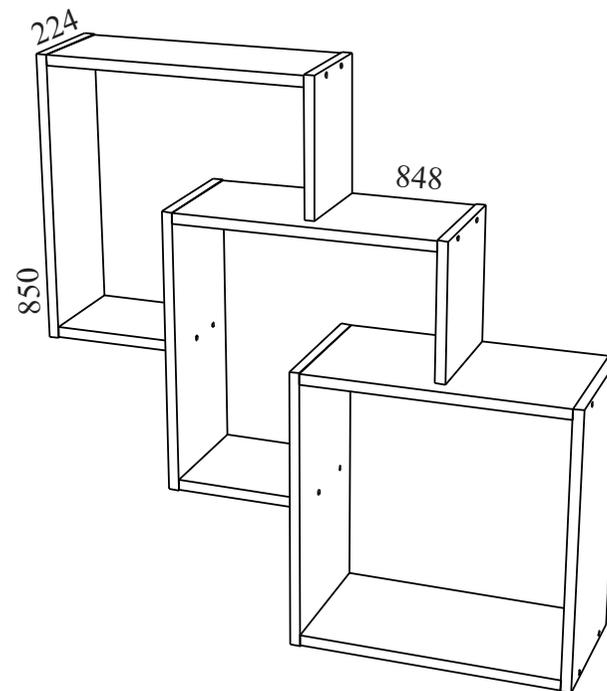
Габаритные размеры: длина - **848 мм**, высота - **850 мм**, глубина - **224 мм**.
