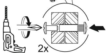
Скрепите модуль с другими модулями с помощью межсекционных стяжек. Для их установки предварительно просверлите два отверстия Ø 5мм. в рекомендуемых местах (как на рисунке).
