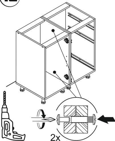
Скрепите модуль с соседним с помощью межсекционных стяжек. Для их установки предварительно просверлите два отверстия  $\varnothing 6\text{мм}$  в рекомендуемых местах (как показано на рисунке).
